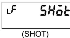
触发输出功能可在比较输出导通后的一个设定间隔后断开比较输出。以下曲线图给出了 K3HB-S 上的触发输出设定为 10ms 时的运行。
