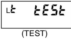
输出测试功能可使用按键来设定测试测量值，检查设定的比较设定值下的比较输出。
