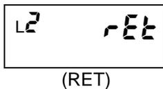
在RUN级或调节级下，如果指定时间内未执行键操作，则显示自动返回至电源接通时激活的显示状态。显示自动返回的时间可进行设定，并可通过该设定禁用自动返回。
